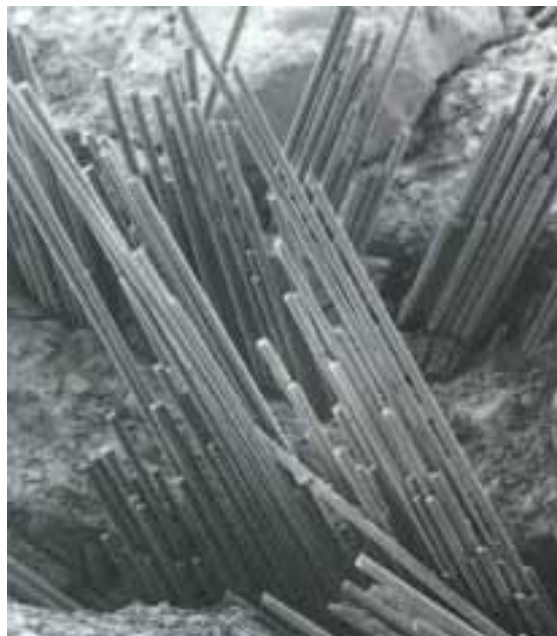
Obr. 1 Pramen vláken Cem-FIL ANTI-CRAK HP v betonu – zvětšeno
